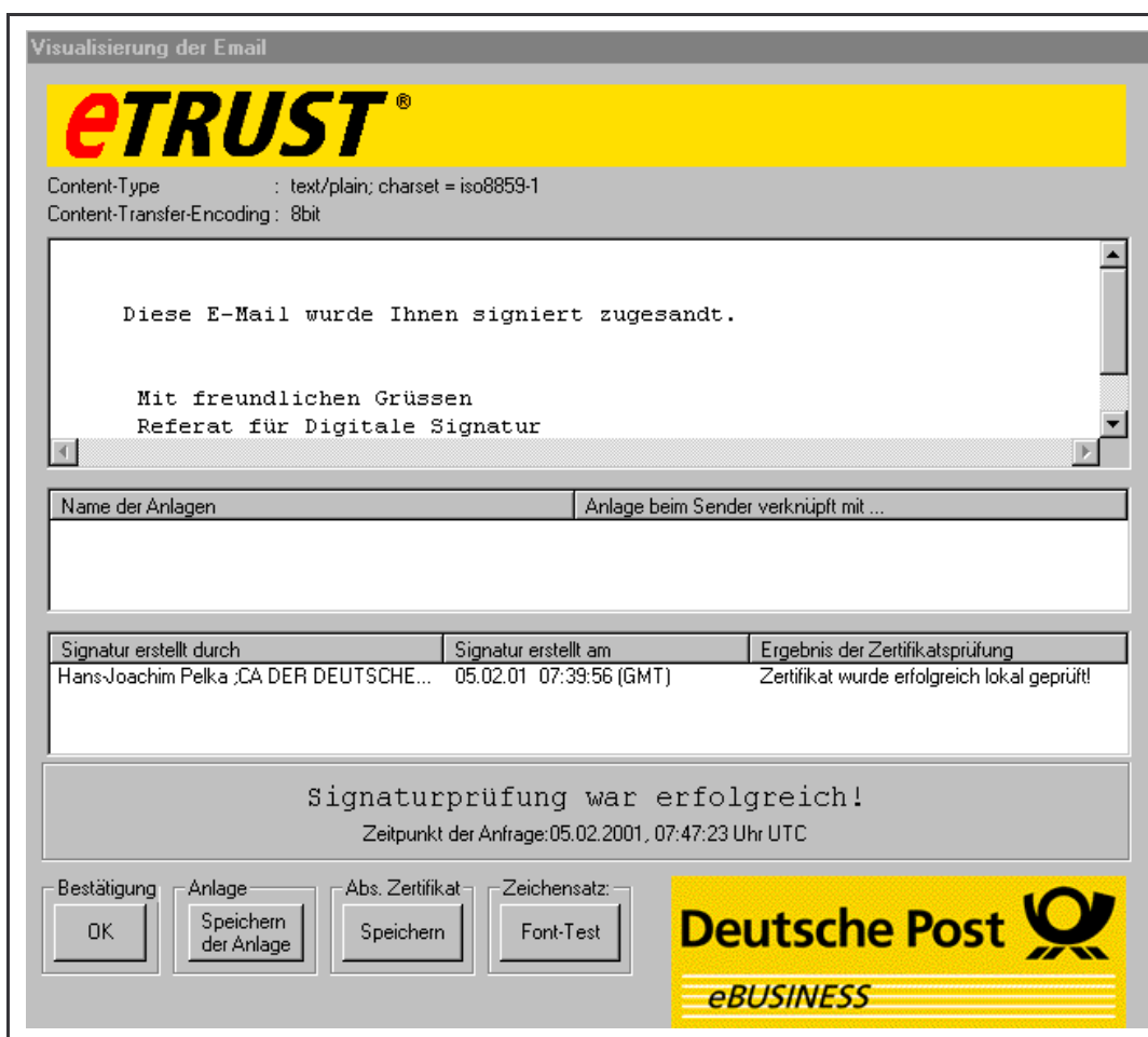
Abbildung 23: Prüfung der Signatur mittels Zertifikat und Prüfsoftware
